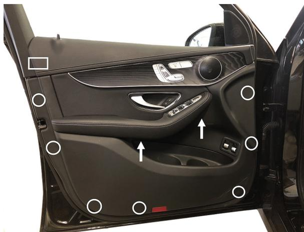
Je nach Modell befindet sich links oben (linke Tür) bzw. rechts oben (rechte Tür) ein Arretierungshaken. Verschieben Sie die Türverkleidung seitlich um diesen zu lösen.
